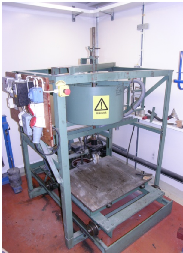
Figur 4.1 Provningsutrustning enligt RWA
