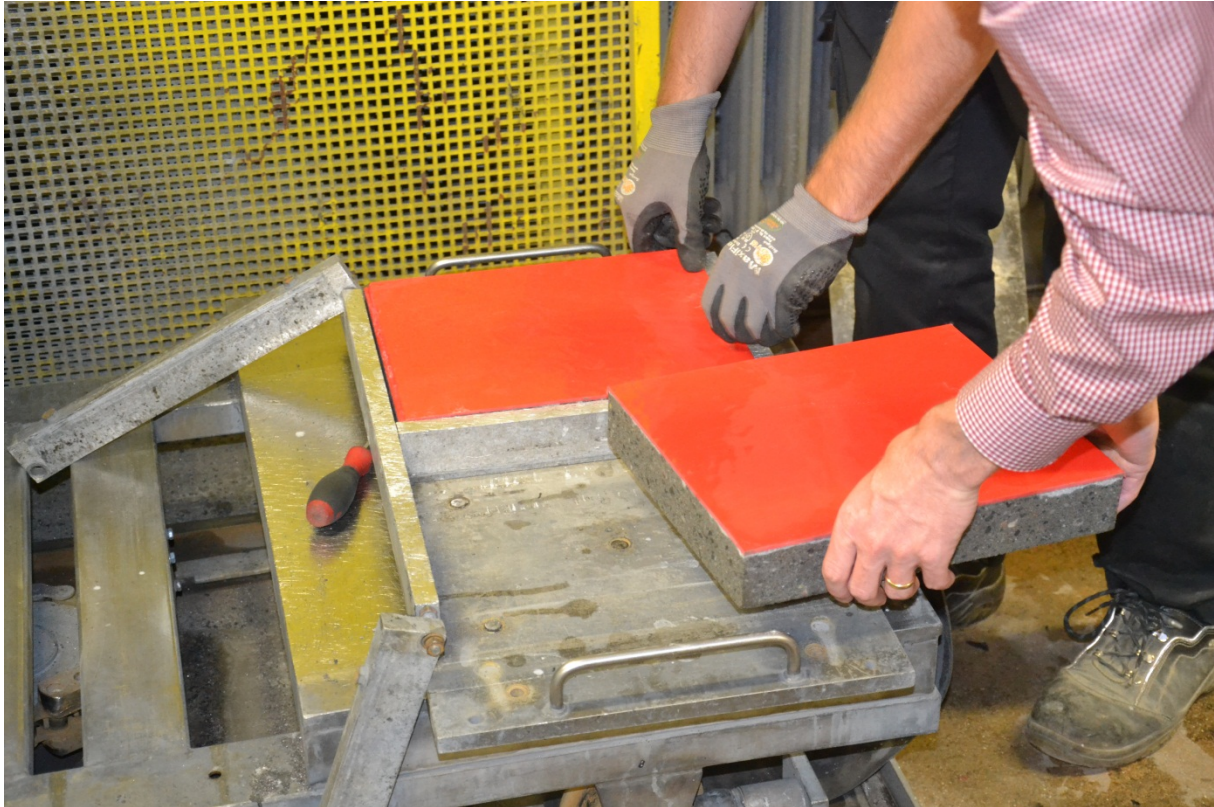
Figur 2.2 Provplasser med h rdplast (polyurea) monteras
