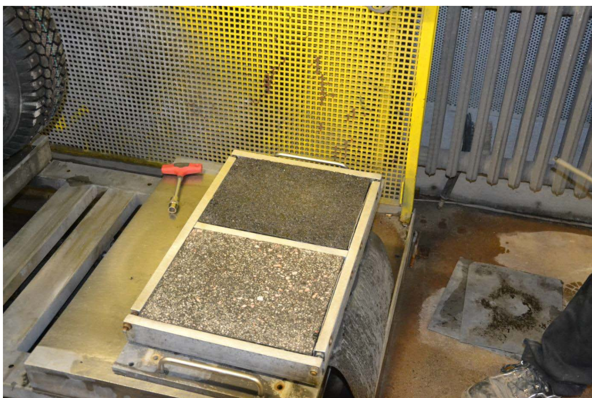
Figur 2.1 Monterade provplattor med gjutasfalt (med och utan BCS)
