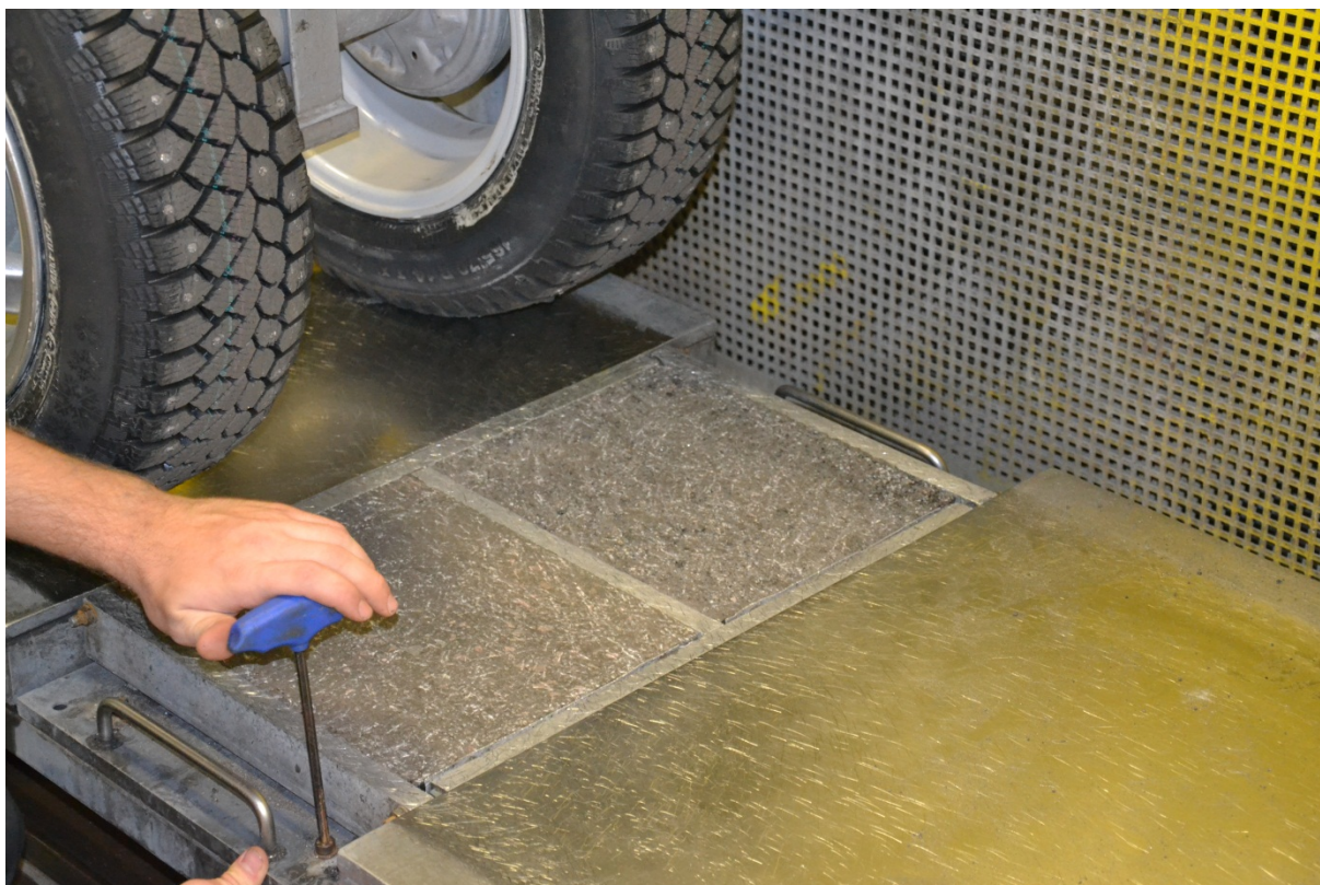
Figur 2.3 Gjutafalt efter avslutad provning 15 minuter
