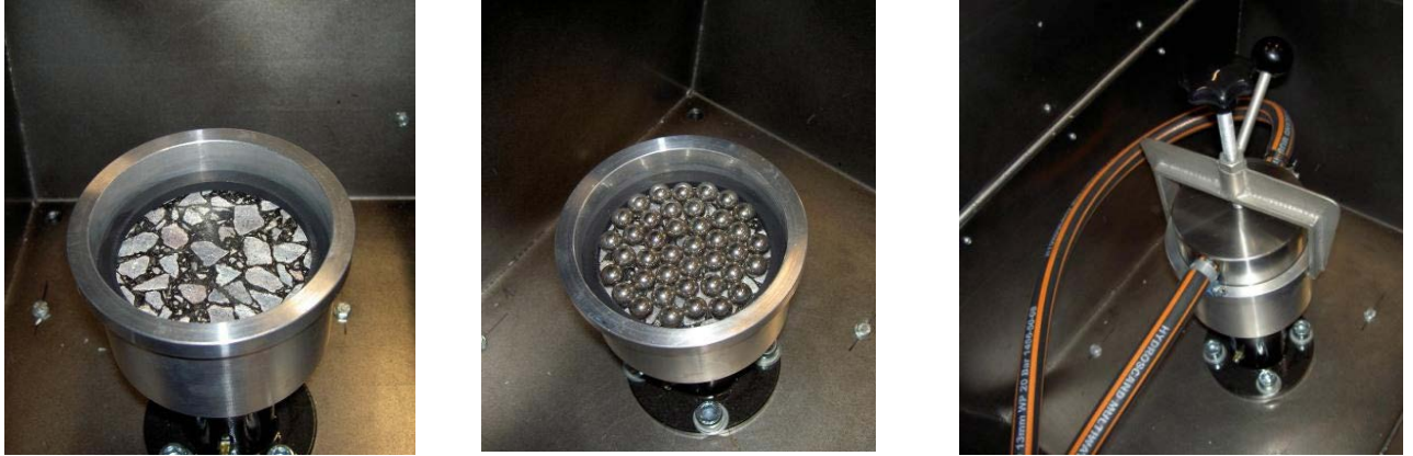
Figur 4.2 Provningsutrustning enligt Metod A - Prall
